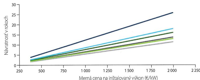
V grafe uvedené výsledky zodpovedajú čerpadlám, ktoré dodajú ročne 2 300 kWh tepla na 1 inštalovaný kW výkonu. Pri výpočte boli použité hodnoty SPF podľa tabuľky na strane 5 a cena elektrickej energie 0,135 €/kWh. Úspora nákladov bola prepočítaná pri cene tepla 0,10 €/kWh (28 €/GJ). Pri čerpadle vzduch/voda bola započítaná 16% potreba doplnkovej elektrickej energie v dňoch s priemernou teplotou pod -7 °C pre II. klimatickú oblasť.
