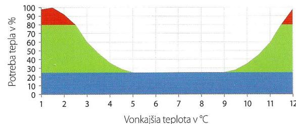
**Dohrev** – doplnkové teplo z bivalentného zdroja, napríklad priamy elektrický doohrev
